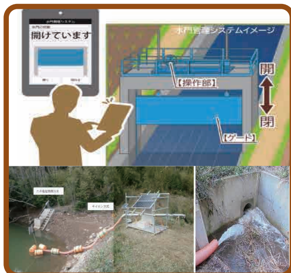
ため池・水門管理システム
